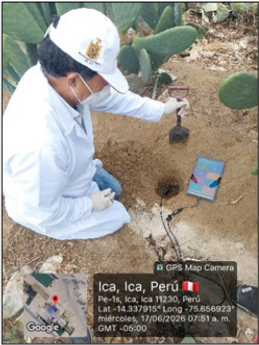
Figura 2. Medición in situ de los parámetros físico-químicos del suelo agrícola mediante el detector multiparámetro CHTR-8IN1-01, distrito de Santiago, Ica-Perú.
