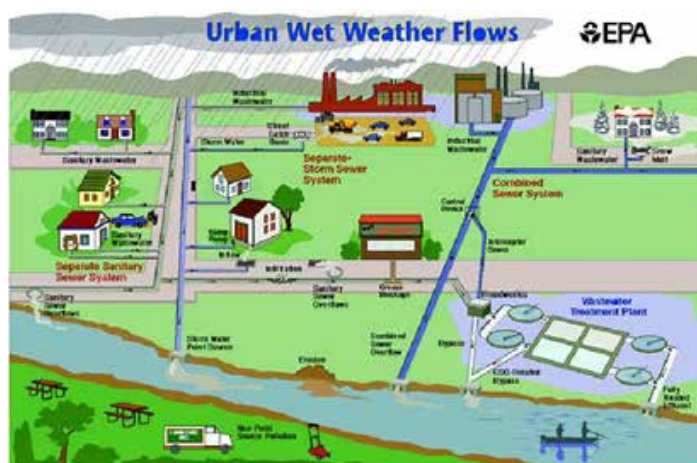
Figura 1: Apresenta um esquema elucidativo dos tipos de sistemas de drenagem unitários e separativos (EPA, 2013, citado por Albino, 2013).
