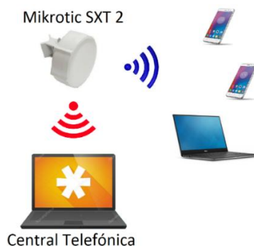
Fig. 1 Estructura genérica de la propuesta de plataforma de telecomunicaciones. Elaborado por el autor.
